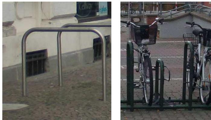
Abbildung 5.1 Abstellanlagen, die den benannten Standards entsprechen: Fahrradbügel (links) und Beta-Parker (rechts)
