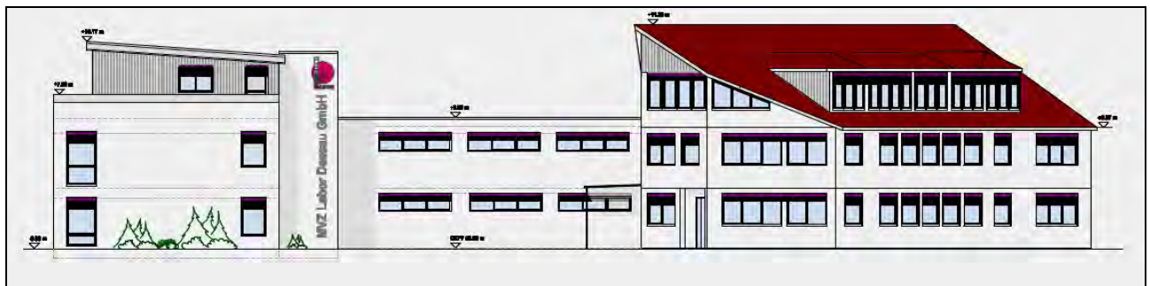
Abb. 7: Straßenabwicklung des Erweiterungsbaues mit Staffelgeschoss (links) gegenüber dem Haupttrakt (rechts). Obwohl der Haupttrakt visuell wie ein dreigeschossiges Gebäude wirkt, gilt es wegen der „Zwei-Drittel-Regel“ der alten Bauordnung Sachsen-Anhalt als zweigeschossig. Vergleiche hierzu auch Zeichnung-BI.-Nr. 5. (Entwurf und Zeichnung: RIK – Kathleen Gerth)
