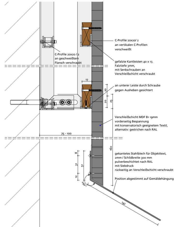
Detail Schnitt B-B | unterer Anschluss mit Objektträger | M1:3
