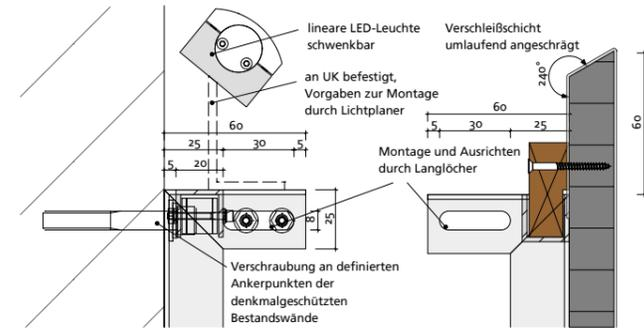
Detail Schnitt B-B | oberer Anschluss mit Beleuchtung | M1:3
