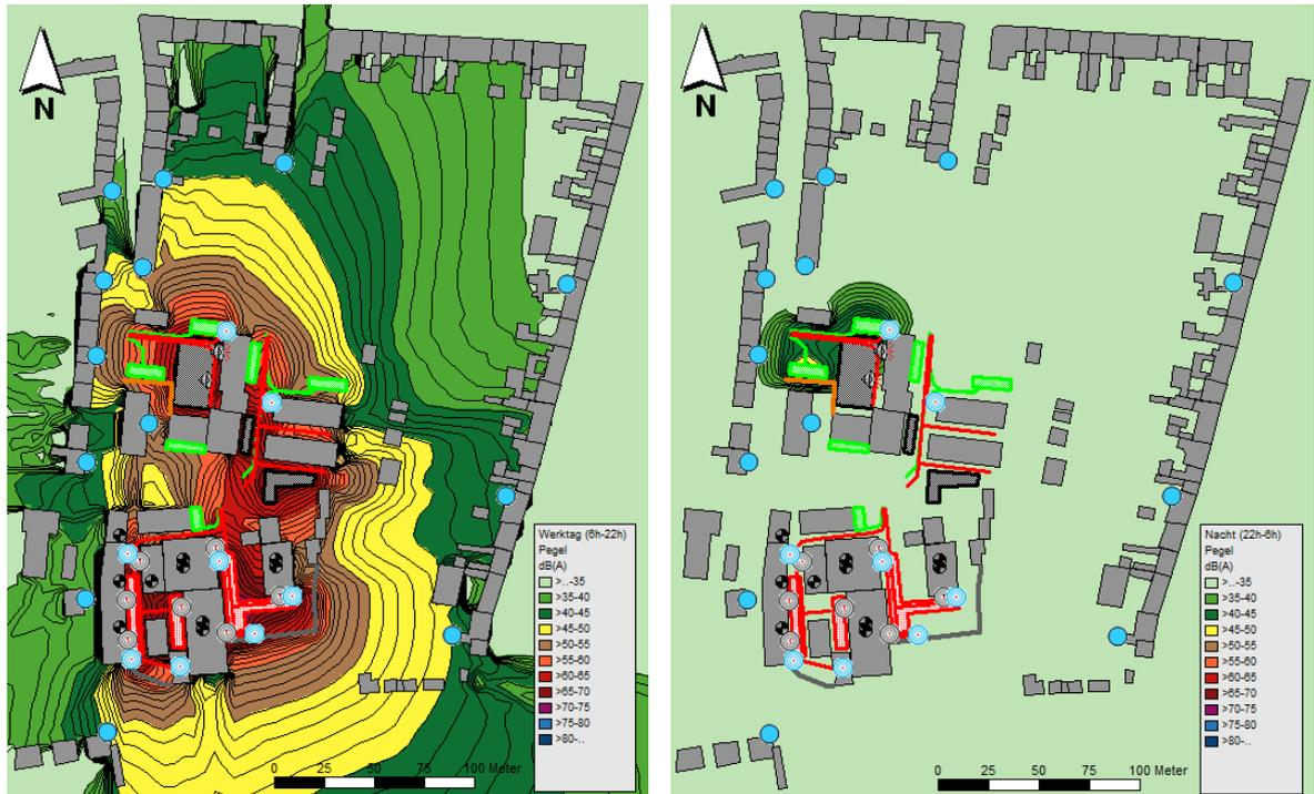
Bild 6: flächendeckende Beurteilungspegel in 4 m Höhe (links: Tag, rechts: Nacht)
