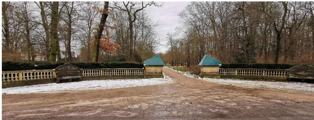
**Ist:** Das Wegesystem besteht hauptsächlich aus einer wassergebundenen Decke mit roten Einkornsplit. Daneben gibt es Bereiche mit gelber wassergebundener Decke und Rindenmulch.
