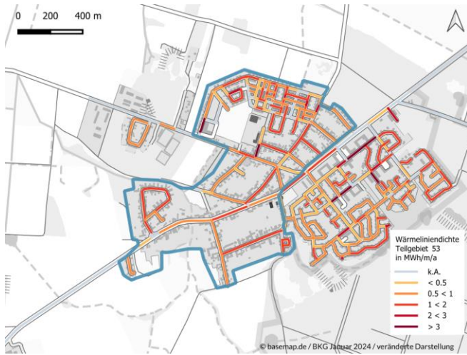
Wärmeliniedichte (Indikator für Wärmenetz)
