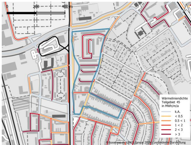
Wärmeliniedichte (Indikator für Wärmenetz)
