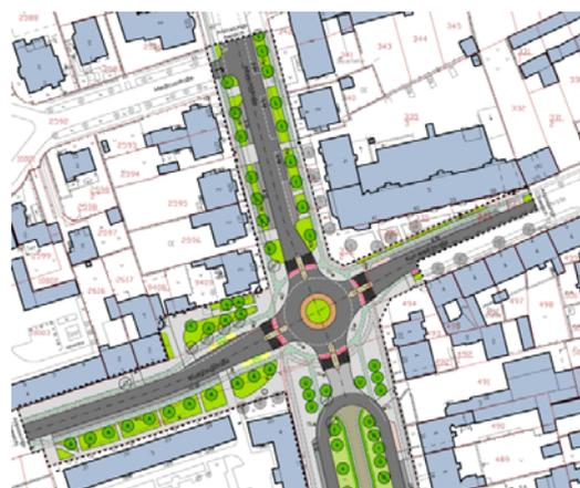
Ausbildung der Zu- und Ausfahrten des Kreisverkehrs ermöglicht eine Reduzierung des bestehenden Fahrbahnquerschnitts in allen Knotenarmen zu Gunsten der Flächen, die für Fußgänger und Radfahrer sowie für Parkplätze und Grünanlagen zur Verfügung stehen. Um die Erschließungsqualität des Albrechtsplatzes durch Stadtbusse zu erhöhen, werden in der Wolfgangstraße zwei zusätzliche Haltestellen eingeordnet. Die Führung
