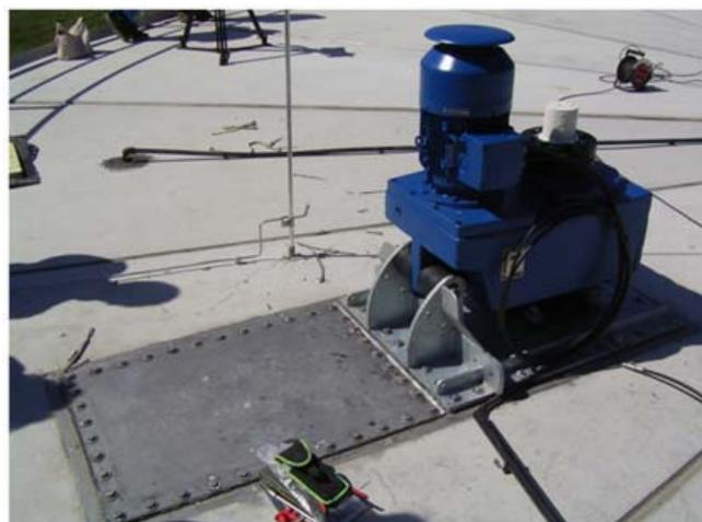
Paddelrührwerk mit außen liegendem Rührwerksmotor und Wälzlagerung im Ferment. Es werden max. 6 Rührwerke mit ögelagerten Getriebe als Langsamläufer mit 8 Umdrehungen/ Minute eingesetzt, von denen jeweils immer nur 2 Paddelrührwerke für 20 Minuten/Stunde in Betrieb sind. Im unteren Bereich sind max. 4 Stabmixer vorgesehen, von denen jeweils 2 für 20 Minuten/ Stunde in Betrieb sind.
