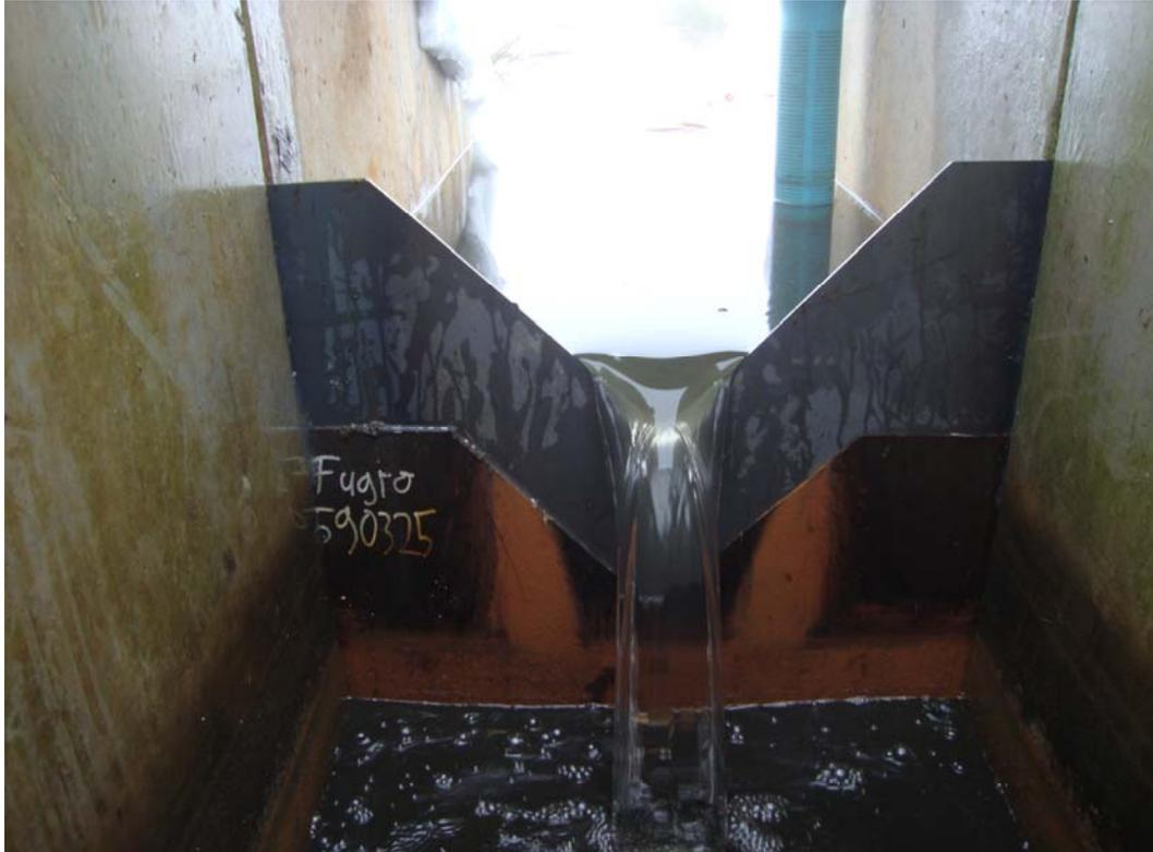
Abbildung 3-1: Fotodokumentation des THOMSON Wehres (Blick stromauf)
