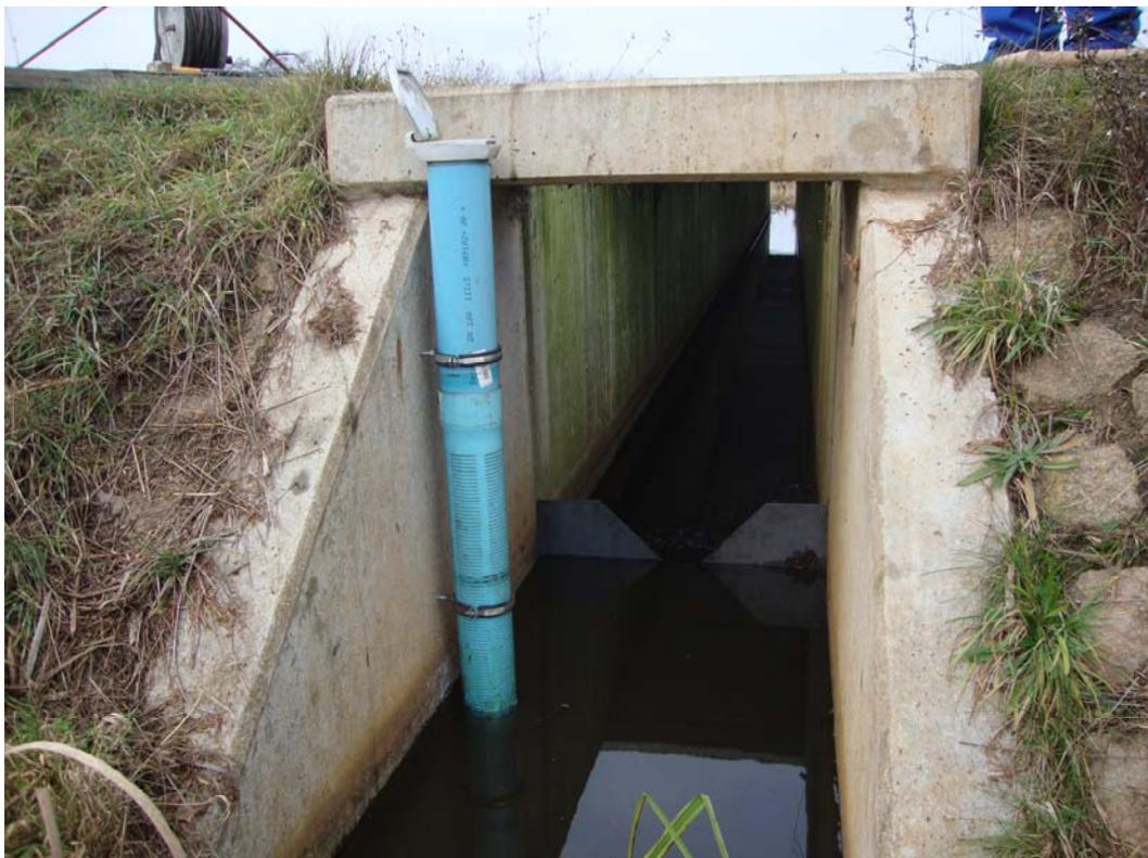
Abbildung 3-2: Fotodokumentation der Messeinrichtung des Datenloggers im Oberwasser des THOMSON Wehres
